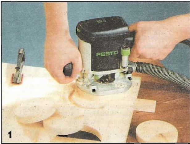
1 Круглые отверстия в крышке и промежуточной полке тумбы вырезают с помощью фрезерной машинки, к опорной плите которой ...
