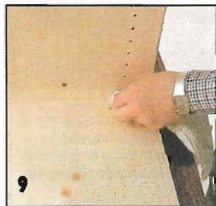
После окончательного соединения деталей стык еще раз тщательно протирают влажной тряпкой.
