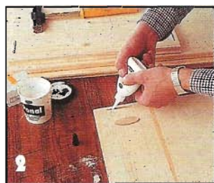
В заранее профрезерованные пазы клей вводят прямо из тюбика.
