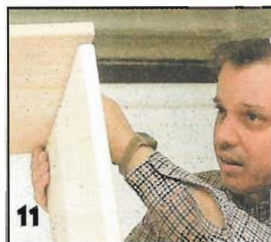
На шпонках с клеем соединяют с боковыми стенками крышку корпуса.
