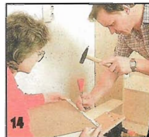
Выдвигаемые ящики собирают так же, как и корпусные элементы, и крепят к ящикам металлические шины.
