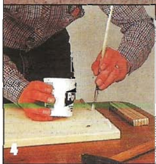
Выступающие части шпонок промазывают клеем.
