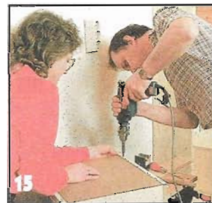
Направляющие крепят к выдвигаемым ящикам шурупами.
